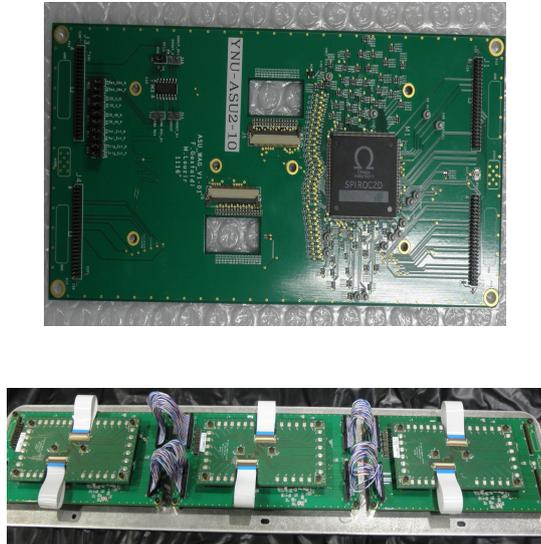
図 5.3: ASU(上)と Single MPPC Card を取り付けた ASU を 3 枚接続したものの(下)
