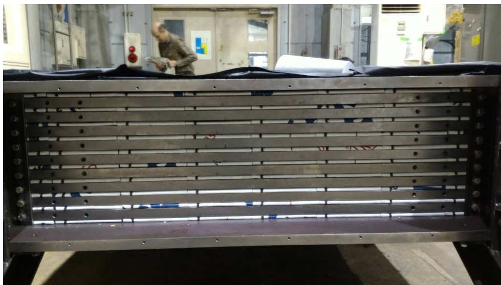
図 5.8: シンチレータ挿入後の構造体
