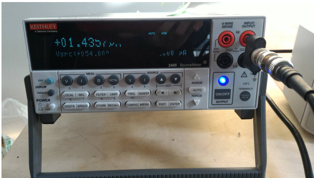
図 5.16: 貫通穴を塞ぐ前の Top Cover 側の MPPC の信号の電流値
