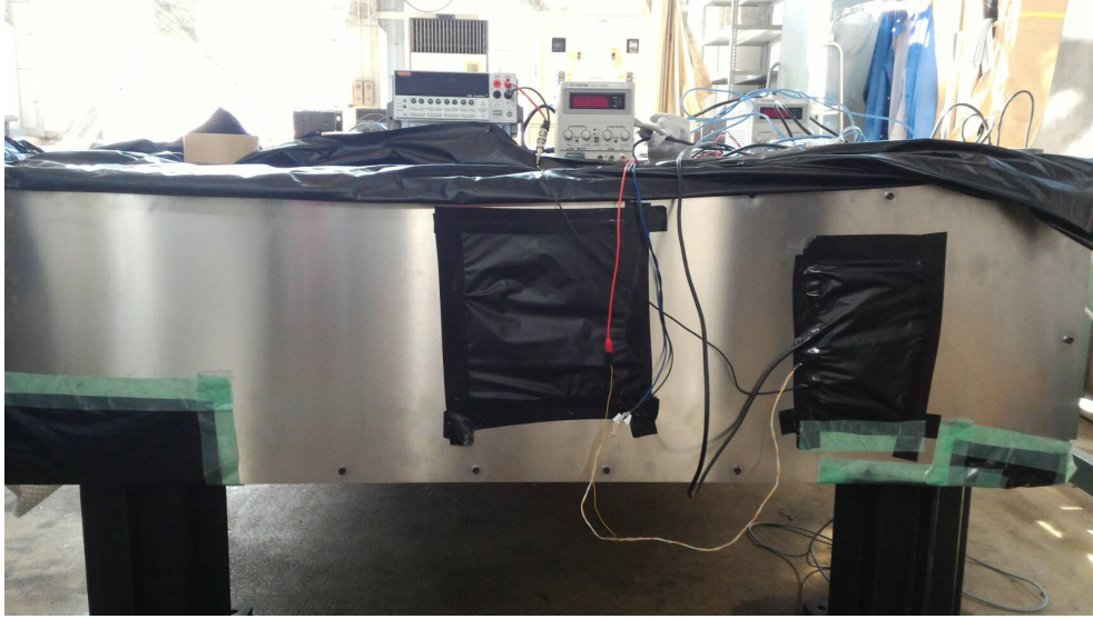
図 5.23: Top Cover 取り付け及びブラックシートで貫通穴を塞いだ図
