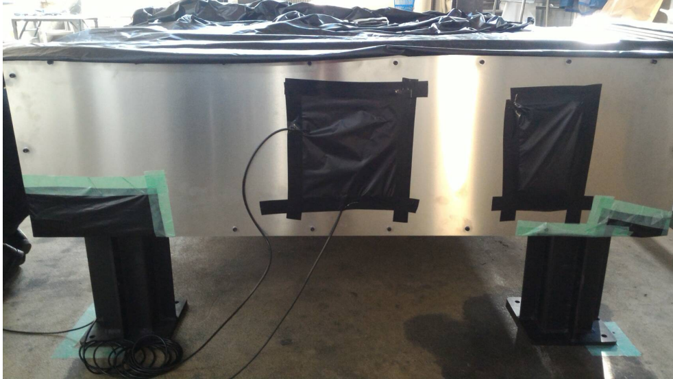
図 5.17: 貫通穴を塞いだときの Top Cover 側の測定の様子
