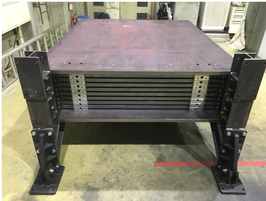
図 5.4: 組み立て直後の sideMRD 構造体
