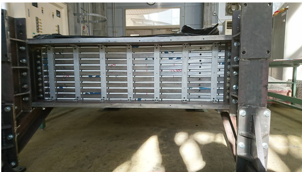
図 5.9: Support Bar 取り付け後の構造体
