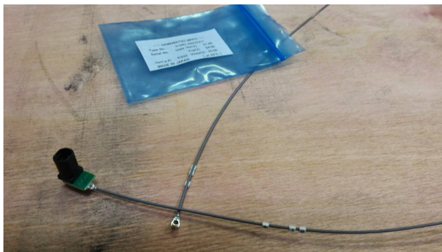
図 5.11: MPPC、オプティカルコネクタ、PCB ボード、同軸ケーブルのセット
