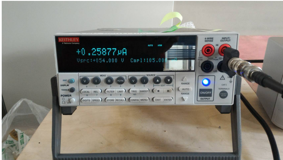
図 5.19: 貫通穴を塞ぐ前の Bottom Cover 側の MPPC の信号の電流値
