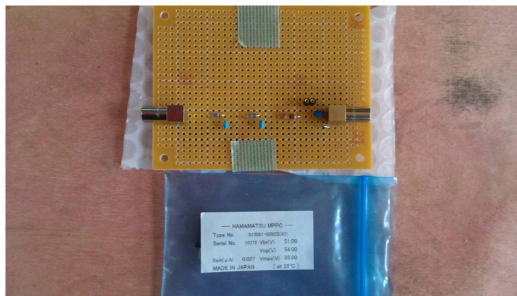
図 5.14: 使用した MPPC 及び MPPC 信号読み出し回路
