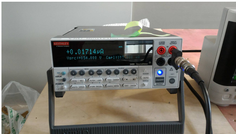
図 5.18: 貫通穴を塞いだ後の Top Cover 側の MPPC の信号の電流値
