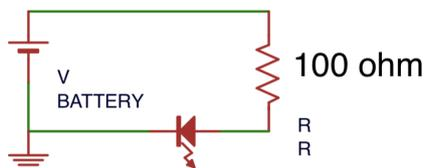
図 4.18: LED ドライバの回路図
