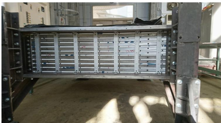
図 3.4: Side-MRD のサンドイッチ構造
