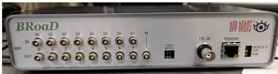
図 4.10: プログラム NIM 信号処理装置 BRoaD
