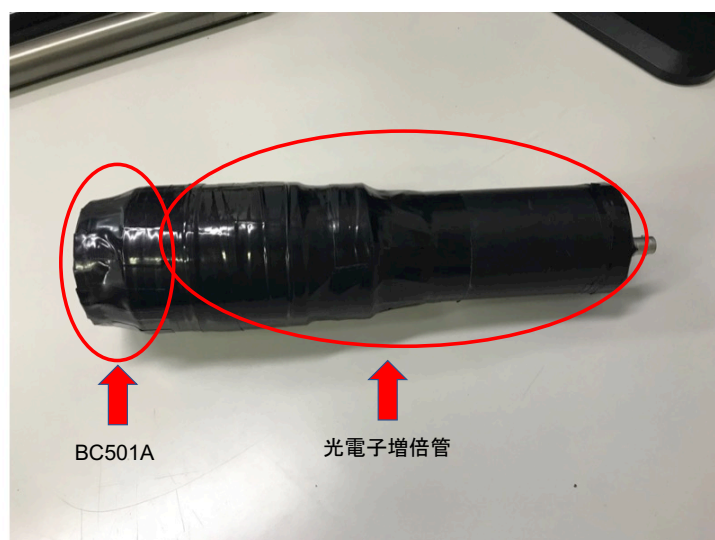
図 2.2: 液体シンチレータ BC501A と光電子増倍管
