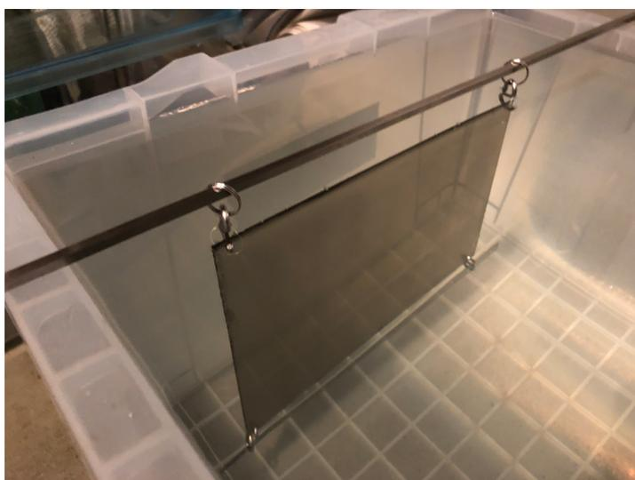
図 3.8: 水浸中の原子核乾板。四隅に穴を開けフックで引っ掛け金属棒に通して固定。出来るだけ液中でも乾板が動かないようにもう他方にも同じように施している。3~5分おきに水から取り出し厚みを計測する。
