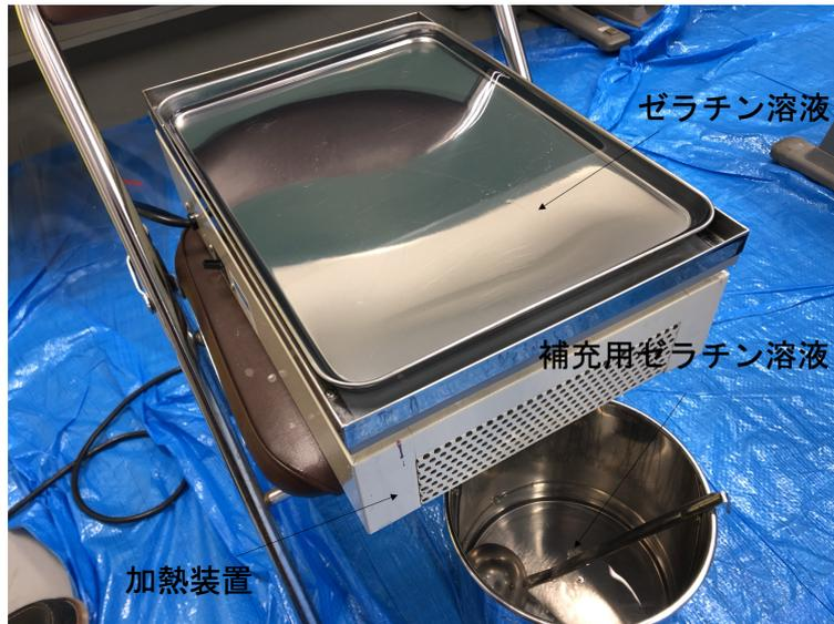
図 3.5: 下塗り処理用のゼラチン加熱装置。トレーにゼラチン溶液を移すのはプラスチックベースをくぐらせやすくするため。ベースをくぐらせたら鍋の上でよくゼラチンを切って乾燥へ移る。
