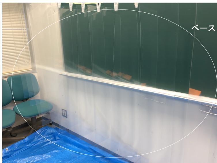
図 3.6: ベースの乾燥の様子。洗濯バサミ付きの紐を部屋の上部に固定してベースを洗濯バサミで等間隔に挟んで吊り下げる。ゼラチンがベースから垂れずに残って固まらないように定期的にケイドライで吸わせるようにして拭き取る。
