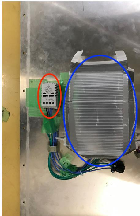
図 71: エレキボックスのカバー内側に取り付けられている温度制御器 (赤丸内) 及びクーリングユニット (青丸)。
