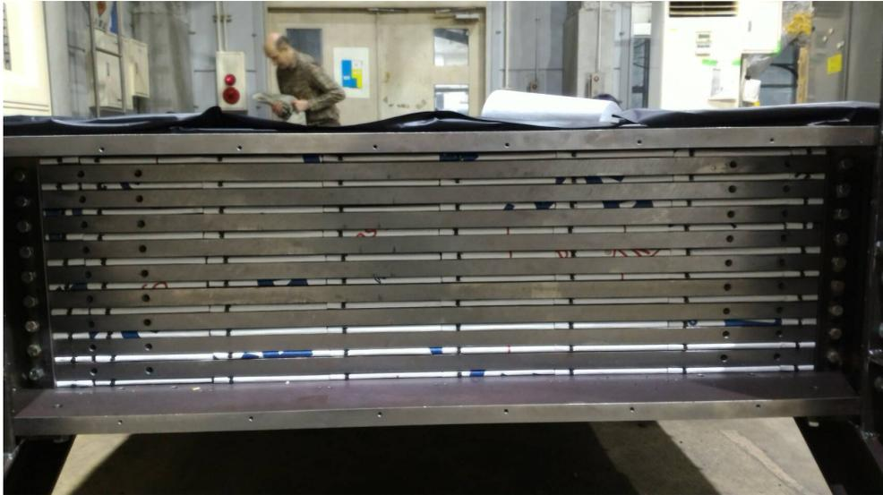
図 44: シンチレータ挿入後の構造体
