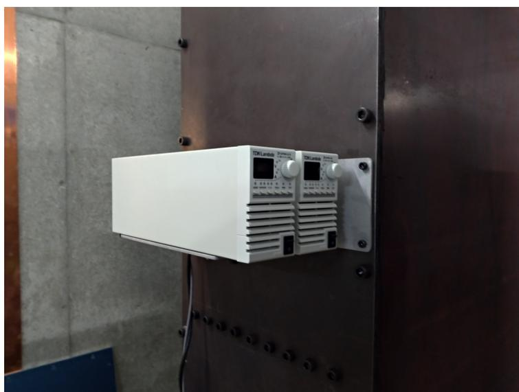
図 69: WAGASCI および Wall MRD に使用している直流安定化電源 ZUP。図は Wall MRD 構造体側面に設置した ZUP 6-33(奥側) および ZUP80-2.5(手前側)。
