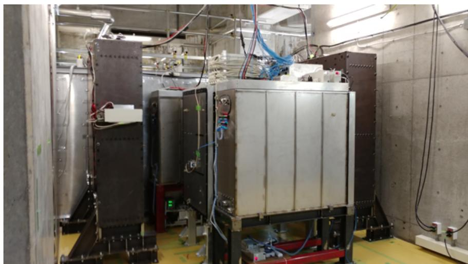
図 75: 検出器を用いた測定試験を行うことができる状態になった実験現場の様子。一番手前中央側の検出器が WAGASCI(ニュートリノビーム上流側)、その後ろに Proton Module、Proton Module の後ろに WAGASCI(下流側)、それら検出器の側面に設置された検出器が Wall MRD。
