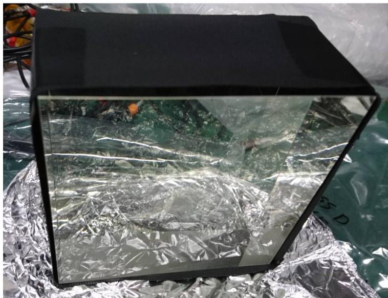
図 5.1: 発光調査で使用した光学研磨ガラスブロックサンプル (R12860 新ガラス)。本測定を行う際に側面をブラックシートで覆った。
