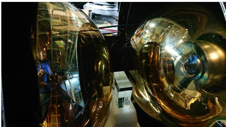
図 5.2: 放射線源を用いた測定のセットアップの写真。向かい合わせにした R12860 とその間に光学研磨ブロックサンプルを置いている。測定の際に R12860 と光学研磨ブロックサンプルはお互いと面している  $10 \times 10$  cm 角以外をブラックシートで覆っている (この写真ではブラックシートは取り除いてある)。
