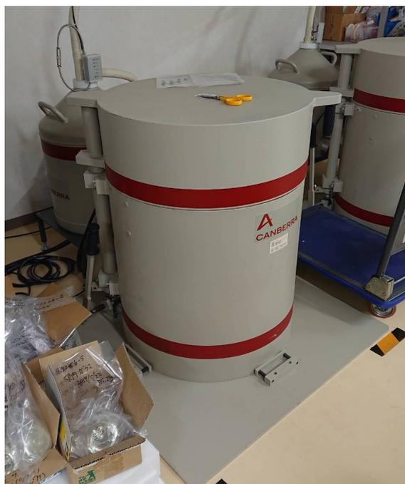
図 4.1: 放射性不純物含有量測定に使用した HPGe 検出器。神岡地下実験施設にある。
