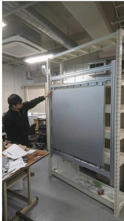
図 3.5: 2019年11月から2020年2月までのニュートリノビーム測定で用いたエマルジョンシフター [6]
