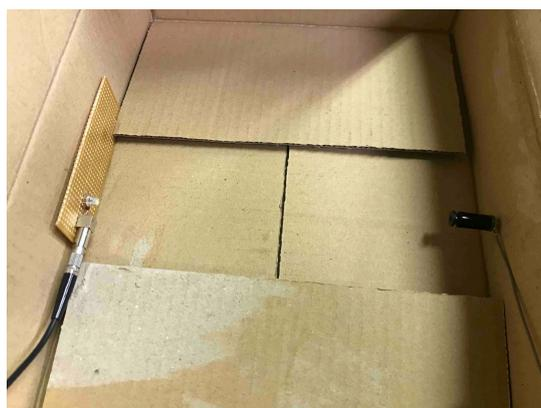
図 5.2: LED (左側) と MPPC (右側) の配置
