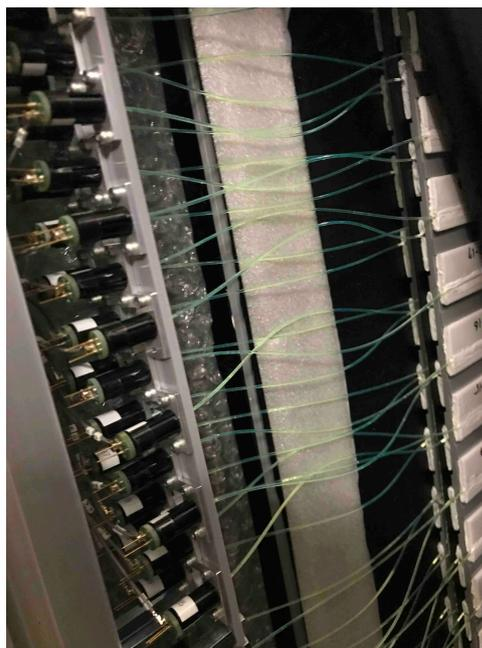
図 3.6: シンチレーショントラッカー: y 軸 (横向き) のプラスチックシンチレータバー
