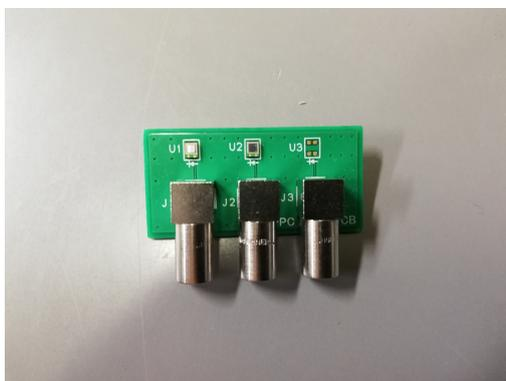
図 4.1: 本研究で使用した表面実装型 MPPC (S13360-1325PE)
