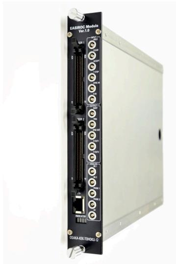
図 4.2 EASIROC module の写真 [10]
