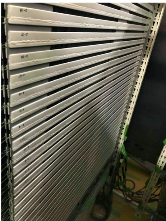
図 3.6 横向きに配置されたプラスチックシンチレータ [8]
