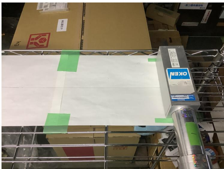
図 4.7: background 測定のセットアップ。ratio 測定と同様の測定回路で AmBe 線源を取り除き測定を行った。
