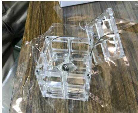
図 1.4: SKで用いられる AmBe 線源+BGO シンチレータ [7]
