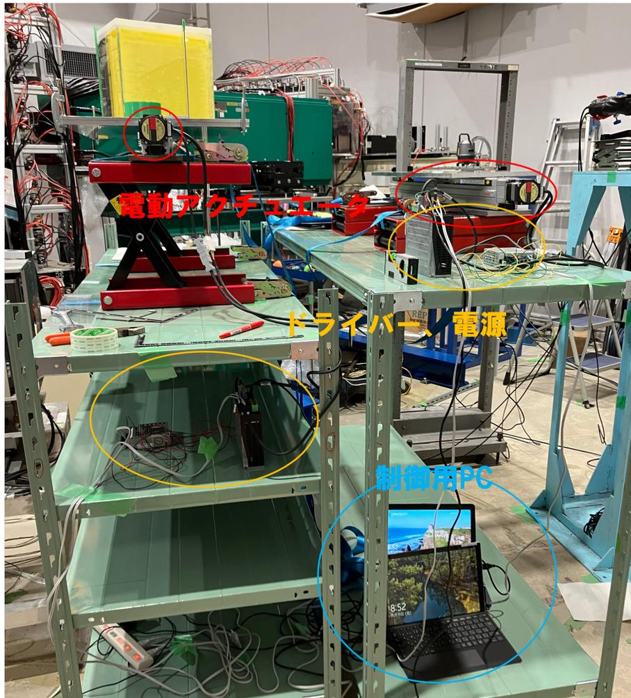
図 2.8: 実験時の電動アクチュエーターセットアップ
