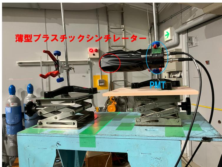
図 2.6: 薄型プラスチックシンチレーターのセットアップ
