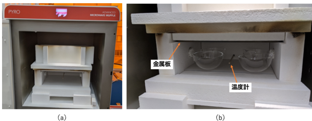
図 46: 灰化処理のセットアップ (a) マイクロ波マッフル炉 (b) アルミナ製の窯
