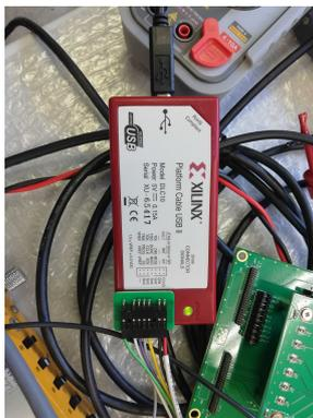
図 6.6: 接続に使用したプラットフォームケーブル
