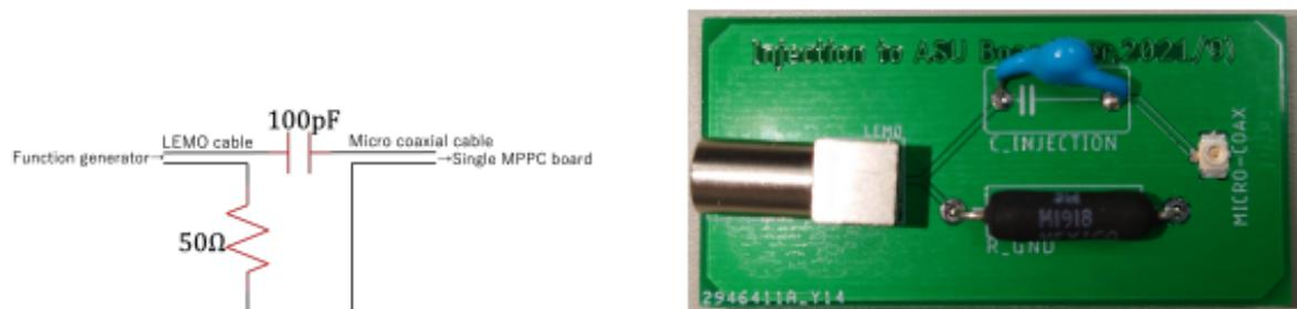
図 5.21: ASU injection board の回路図及び実際の回路 [5]
