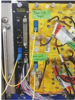
図 6.2: WAGASCI、Wall-MRD のトリガー受信モジュール
